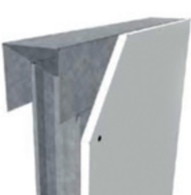
Sequenza costruttiva per realizzare una parete antisismica per interni in cartongesso (Siniat)
